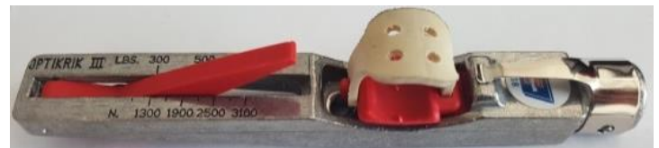
OPTIBELT mehanički uređaj za proveru zategnutosti kaiša
