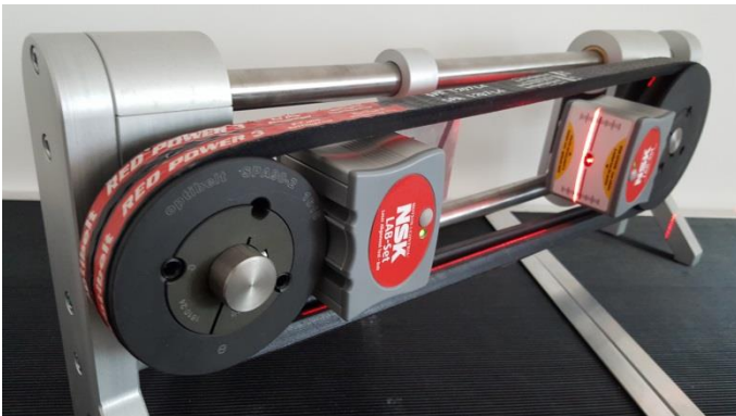
NSK uređaj za podešavanje saosnosti remenica
